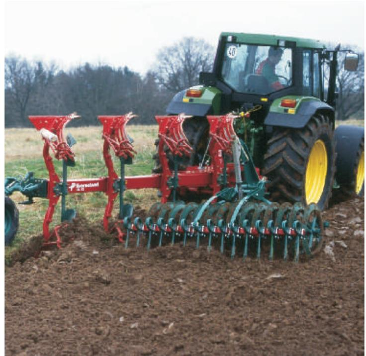
Auch beim Pflügen kann Diesel eingespart werden. Pflüge mit integrierten Packern bieten hierzu gute Möglichkeiten
