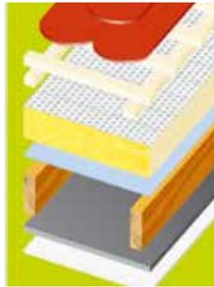
Altes Sparrendach mit 8 x 16 cm Sparren, oberseitig 18 cm Aufsparrendämmung aus Polyurethanplatten, Dämmqualität (WLG) 024
