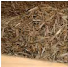
**Hackschnitzel** sind Holzstückchen aus naturbelassenem Restholz. Im Gegensatz zu Holzpellets sind Hackschnitzel nicht genormt und können daher unterschiedliche Beschaffenheit, u. a. hinsichtlich des Heizwertes, aufweisen. Hackschnitzel sind insbesondere für größere Gebäude geeignet, die keine Einschränkungen hinsichtlich des Lagerraums haben.
