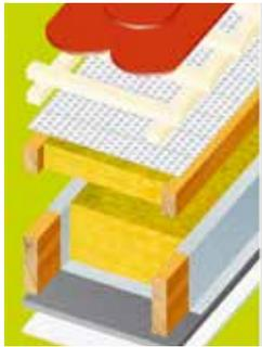
Altes Sparrendach mit 8 x 16 cm Sparren, Aufdopplung mit 6 x 12 cm Konstruktionsvollholz, dazwischen Mineralwolledämmung, Dämmqualität (WLG) 035
