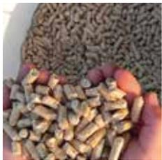
**Holzpellets** sind genormte zylindrische Presslinge aus getrocknetem, naturbelassenem Restholz. Pellets haben in der Regel einen Durchmesser von 6 – 8 mm und eine Länge von 10 – 30 mm. Ein Kilogramm Pellets hat etwa den gleichen Heizwert wie ein halber Liter Heizöl. Pellets müssen hohen Qualitätskriterien genügen und sollten daher mit dem Qualitätszeichen „ENplus“ versehen sein.
