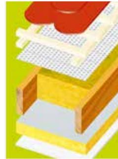
Altes Sparrendach mit 8 x 16 cm Sparren, dazwischen Mineralwolledämmung, Dämmqualität (WLG) 035, darunter 6 cm Polyurethandämmung mit beidseitiger Metallkaschierung, Dämmqualität (WLG) 024
