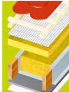
Altes Sparrendach mit 8 x 16 cm Sparren, dazwischen Mineralwolledämmung, Dämmqualität (WLG) 035, oberseitig 10 cm Aufsparrendämmung aus Holzfaserplatten, Dämmqualität (WLG) 040
